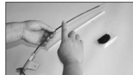
11. Обязательно смазывайте вал винта. Выньте вал, открутив опору и адаптер. Советуем вам смазывать вал после каждых 5ти рейсов. При появлении дефектов на валу, немедленно замените его.
