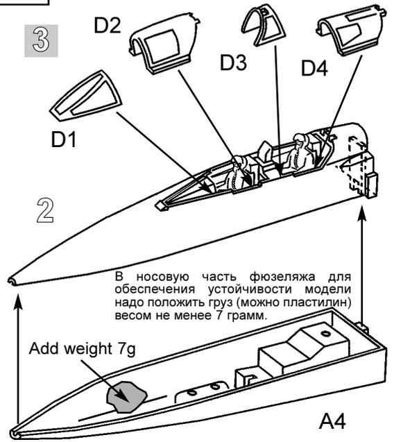
В носовую часть фюзеляжа для обеспечения устойчивости модели надо положить груз (можно пластилин) весом не менее 7 грамм.
