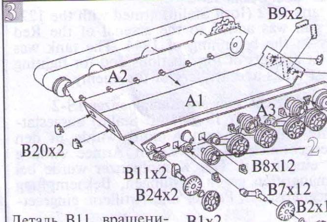
Деталь B11, вращением которой осуществляется натяжка гусеницы, приклеивается в последнюю очередь и фиксируется в нужном положении до полного высыхания клея.
